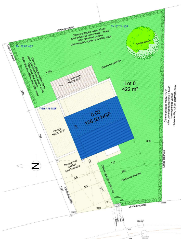
Exemple de plan masse avec les renseignements demandés pour l'instruction du dossier de permis de construire
